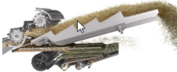
Figure 4 : Ensemble de systèmes de battage, de séparation et de nettoyage
