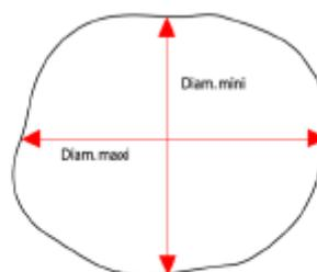
Figure 3 : Mesurage des diamètres en croix sur une pièce méplat à l'endroit du diamètre médian
