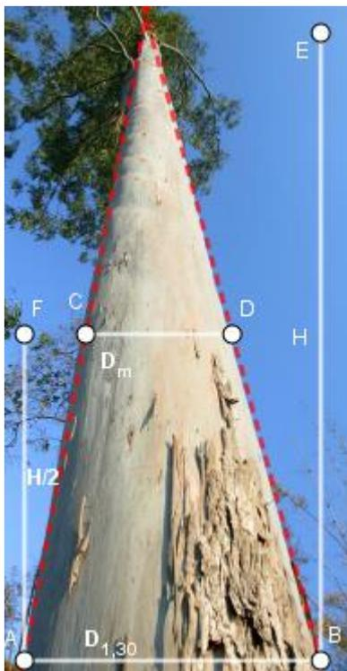
Le diamètre médian  $D_m$  est une mesure essentielle qui permet de réaliser le cubage de bois. Le fait de considérer de manière simplifiée qu'un tronc d'arbre est un cône induit que le diamètre diminue au fur et à mesure que la hauteur augmente et cela en considérant la proportionnalité des accroissements. La hauteur H du bois sur pied étant estimée par une des méthodes développées précédemment, le diamètre  $D_{1,30}$  à hauteur 1,30 m étant mesurée et la connaissance de tables de
