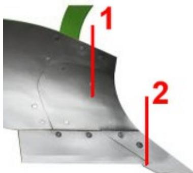
La particularité du corps C-Blade, illustré ici avec le corps universel U 40, est sa partie avant de versoir
