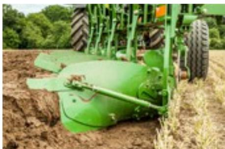
La roue d'appui et de transport combinée, de dimensions 13.0/55-16, représente une particularité technique. Positionnée latéralement sur la charrue, elle permet un labour jusqu'en limite du champ. Le modèle bien étudié assure un passage confortable de la position de travail à la position de transport : il suffit de déplacer un axe pour assurer la sécurité de déplacement.
