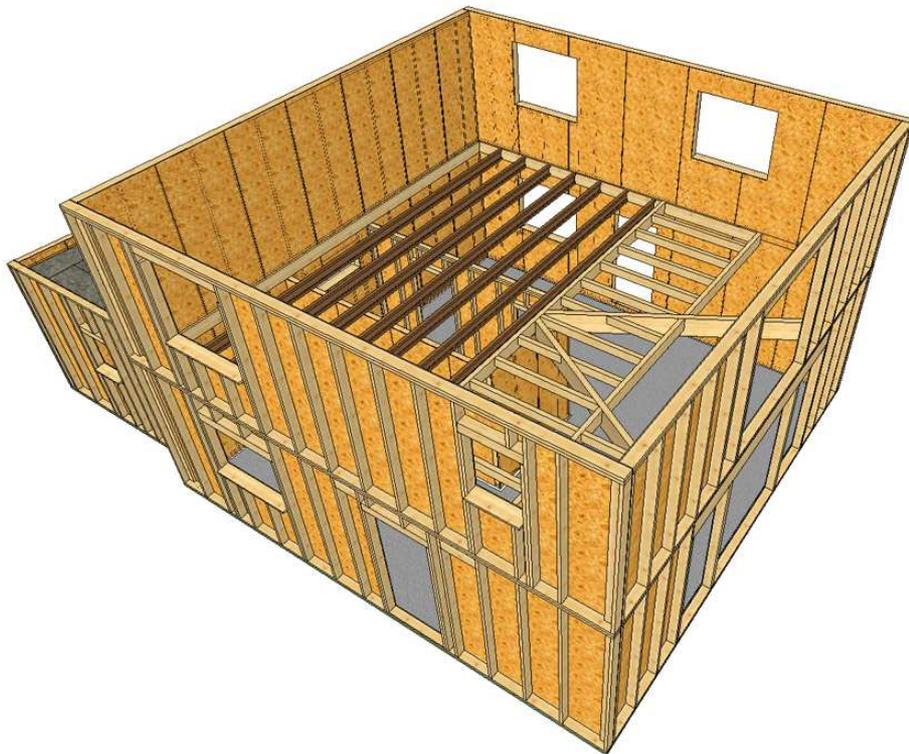
Les murs sont pré-montés en atelier (pas d'interruption pour intempéries, travail été-hiver) puis assembler comme un kit sur le chantier. Cet assemblage avec la pose de la toiture (habituellement de la fermette industrielle) sur chantier dure environ une semaine (mise hors d'eau, hors d'air).
