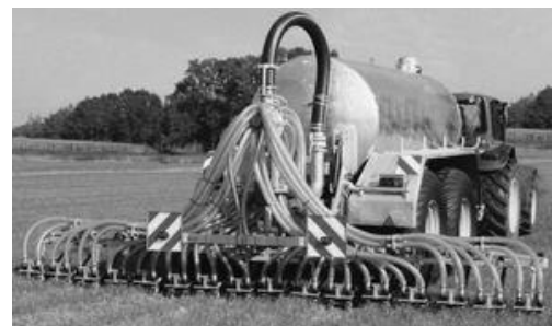
Exemple d'enfouisseur de lisier à disques
